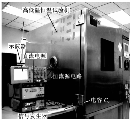
图 10 温度试验装置连接图
